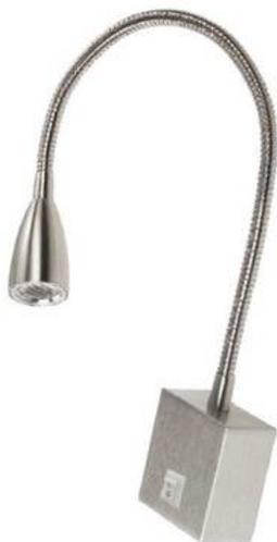
Testaletto con braccio flessibile, con interruttore. Punto luce LED per lettura, versione con base quadrata (DE12S) in diverse finiture. Emissione a 45° per ottenere un effetto di luce accentata. Lunghezza braccio 350mm, Ø8mm. Fissaggio a parete tramite apposita staffa (in dotazione). Alimentazione a 230Vac.
