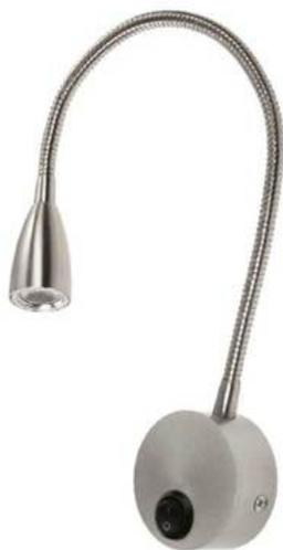
Testaletto con braccio flessibile, con interruttore. Punto luce LED per lettura, versione con base rotonda in diverse finiture. Emissione a 45° per ottenere un effetto di luce accentata. Lunghezza braccio 350mm, Ø8mm. Fissaggio a parete tramite apposita staffa (in dotazione). Alimentazione a 230Vac.
